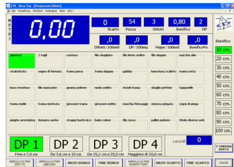
Der Touchscreen-Monitor erleichtert dem Bediener das Markieren und Eingeben von Fehlern.
