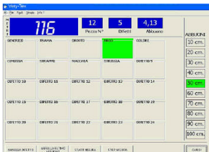
Inserimento rapido dei difetti - Touch express faults entry Introduction rapide des défauts-Introducción rápida de los defectos
